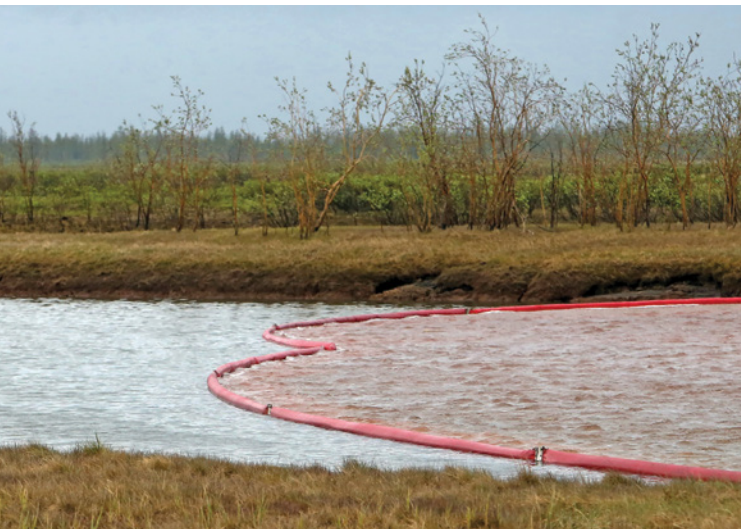
Плавающее заграждение препятствует распространению нефти из-за обширного разлива в реке Амбарная под Норильском, Россия. AFP/GETTY IMAGES
